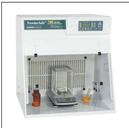
*Especiales para la contención de partículas. En la pared posterior de la cabina se encuentra el área de filtración, la cual limpia el aire de partículas y gases. El diseño genera un ambiente ideal para el pesaje y manipulación de polvos, químicos y solventes cáusticos irritantes o volátiles.*
