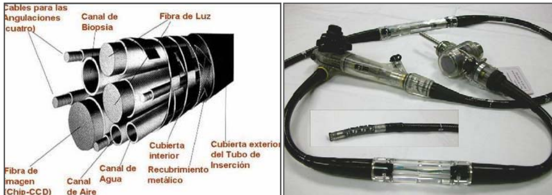
Imagen 7 (A y B)_ Estructura interna del endoscopio
