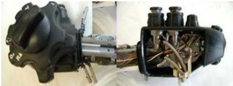
Imagen 10_ Detalle estructura interna del cabezal del endoscopio
