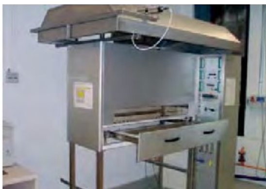
Figura 3. Ensayo de revestimiento de suelos. Panel radiante para suelos (Fuente: Applus)
