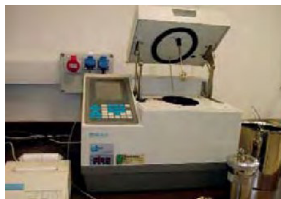
Figura 2. Determinación del calor de combustión. Bomba calorimétrica (Fuente: Applus)
