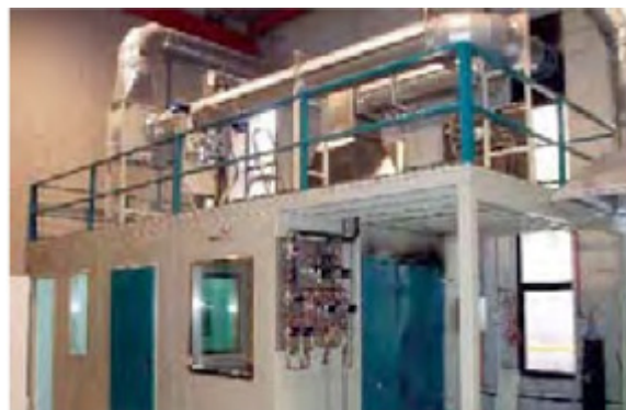
Figura 4. Ensayo SBI (Fuente: Applus)
