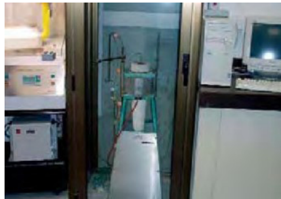
Figura 1. Ensayo de no combustibilidad. Horno cilíndrico (Fuente: Applus)
