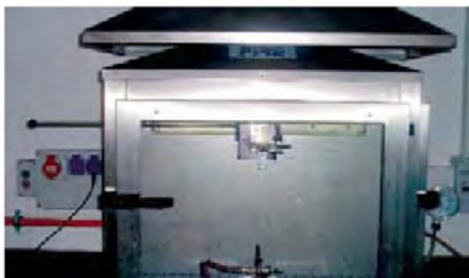
Figura 6. Ensayo con fuente de llama única. Pequeño quemador (Fuente: Applus)
