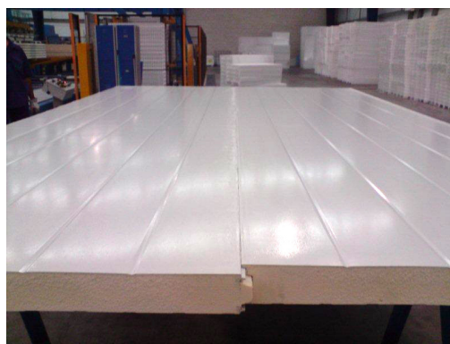
Figura 9. Panel sándwich fabricado. Detalle de juntas (Fuente: IPUR)
