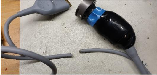
*Cámara de video quirúrgica:* el cable ha sido seccionado por un elemento cortante durante una intervención. Esto ocurrió al recoger el material, ya que se cortaban las tallas para adelantar trabajo y no se observó el cable.
