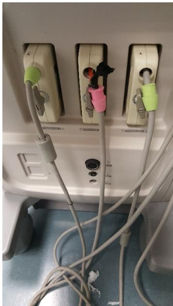
*Cables de sondas de ecografía:* después de su uso, los cables de las sondas no fueron recogidos y fueron atropellados por las ruedas del ecógrafo, lo que ocasionó desperfectos. Estos cables son sumamente sensibles, ya que están compuestos por varios elementos, y su deterioro dificultará la calidad de la imagen de la exploración.
