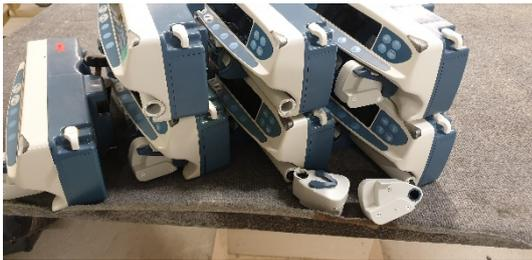
Resultados: caídas recurrentes, con rotura de los mecanismos móviles de las bombas.
