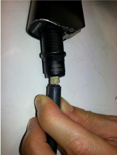
*Motor quirúrgico:* cable en mal estado debido a intentar extraer el conector de forma inapropiada, sin seguir las instrucciones de funcionamiento. Este fallo es bastante común y aumenta considerablemente los costos de mantenimiento.
