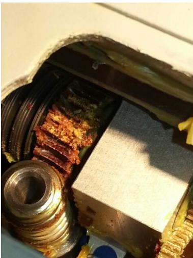
Durante el procedimiento de limpieza, alguien del servicio de esterilización ha sumergido en líquido el motor en repetidas ocasiones, sin aplicar los protocolos de limpieza definidos por el fabricante, lo que ha causado una importante avería en el motor.
