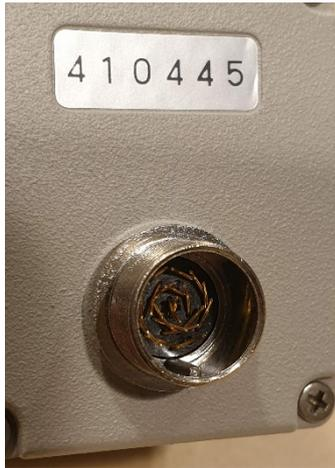
*Cámara de video de microscopio:* se puede apreciar el estado del conector. Un usuario, al querer montar el equipo, provocó la destrucción del conector de la cámara. Debido a la antigüedad del equipo, no se pudo reparar, ocasionando un gasto que no estaba previsto.
