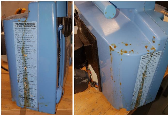
**Limpieza:** otra causa inadmisibles es utilizar bombas en este estado. La suciedad de estos equipos provoca su mal funcionamiento, lo que puede ocasionar infecciones y además genera una imagen negativa de la unidad donde se encuentran. Las infecciones causadas por bombas sucias pueden poner en riesgo la salud de los pacientes y del personal sanitario.
