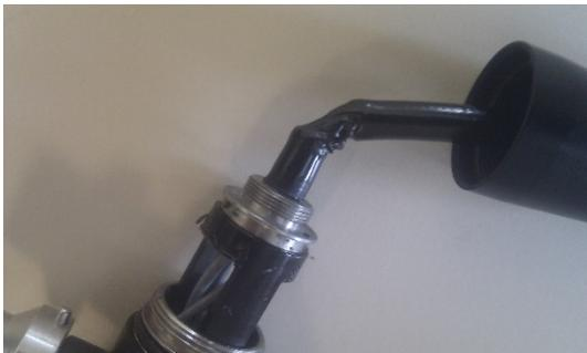
*Endoscopio flexible:* un usuario sin experiencia, desmontó este equipo sin conocimiento ni supervisión, intentando desenroscar el conducto, lo que ocasionó su destrucción.
