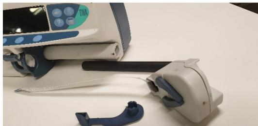
La mala sujeción del equipo provoca la mayoría de los casos de rotura, siendo frecuentes los tropezones debido a cables y tubos mal dispuestos que se encuentran ocultos. Estas caídas ocasionan daños al equipo y pueden poner en riesgo la seguridad del personal.
