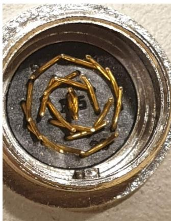
La conexión se realiza introduciendo el conector del cable en la cámara. Para ello, tan solo hay que fijarse en un punto de referencia que esté marcado en el mismo. Sin embargo, el problema radica en que el usuario desconocía la forma de hacerlo e intentó enroscar el conector, lo que consiguió fue retorcer los pines, como se puede observar en la imagen.
