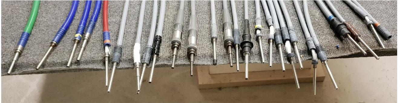
*Cables de luz:* se puede observar la cantidad de elementos que se han deteriorado principalmente por tirar del cable, cuando se debería haber extraído cogiendo el conector de plástico diseñado para ese fin.
