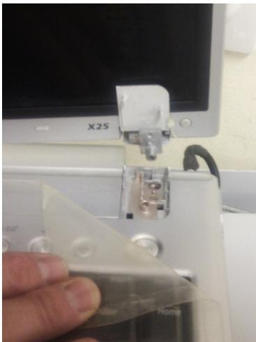
*Ecógrafo portátil:* la imagen corresponde a la pantalla de un ecógrafo portátil alojado en un carro donde se encuentra el resto del equipo. Alguien con poco cuidado estiró de la pantalla para mover el conjunto, arrancando la bisagra y causando daños al conexionado.
