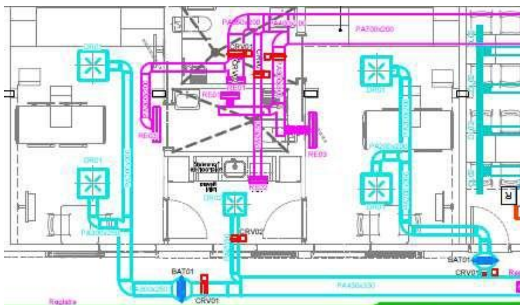
Fig.13 Detalle distribución de conductos en TPH.
